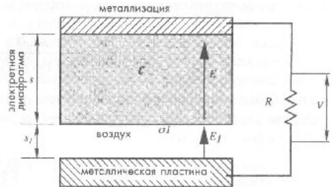
Рис. 5. Структура электретного микрофона.
