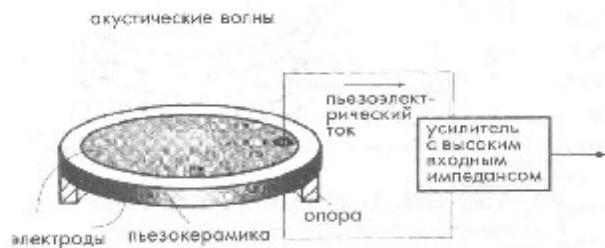
Рис. 4. Пьезоэлектрический микрофон.
