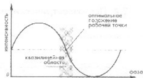
Рис. 3. Зависимость интенсивности излучения от фазы отраженного сигнала.
