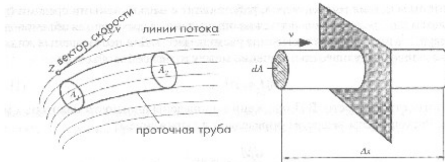
Рис. 1. Проточная трубка, поток вещества через поперечное сечение.
