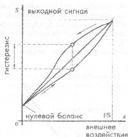
Рис. 3. Передаточная функция с гистерезисом
